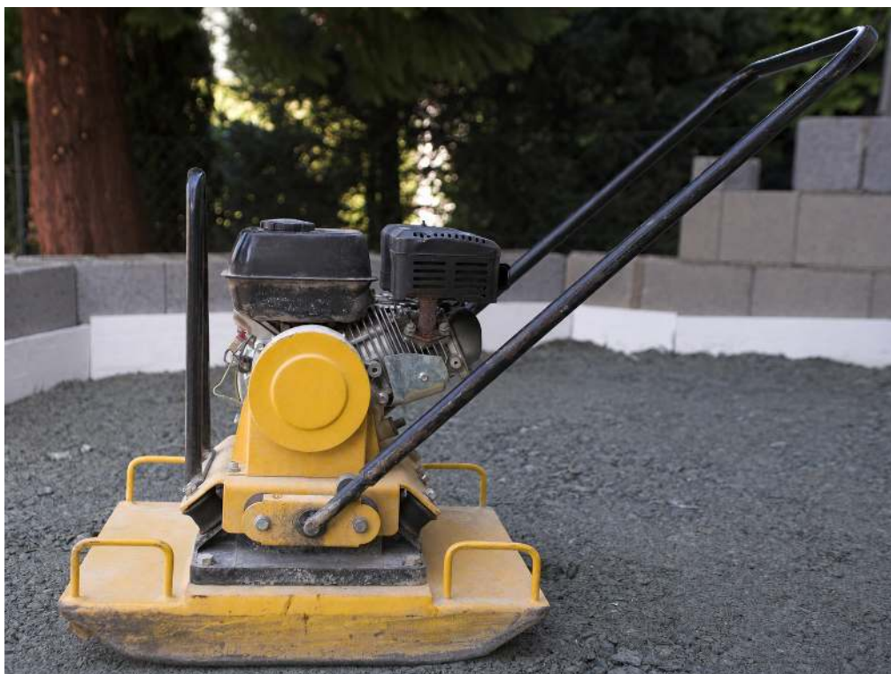
Motor poganja težko spodnjo ploščo, katere vibracije pomagajo zgoščevati plast kamnitega materiala. [73]
