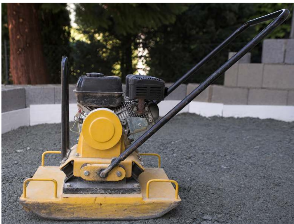
Motor poháňa ťažkú spodnú dosku, ktorej vibrácie pomáhajú zhutňovať vrstvu kameniva. [73]
