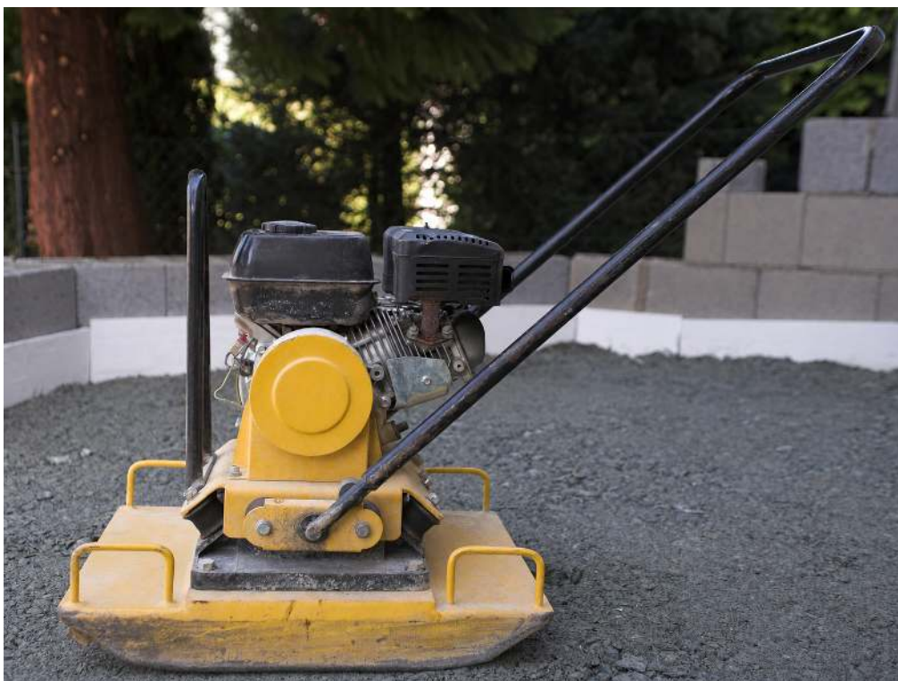
De motor drijft een zware grondplaat aan. Door de trillingen verdicht die de laag steengranulaat. [73]
