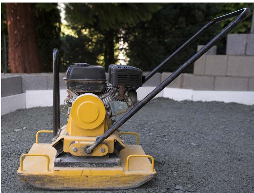
Il motore aziona la pesante piastra inferiore, che contribuisce a compattare lo strato di materiale lapideo grazie alle vibrazioni. [73]
