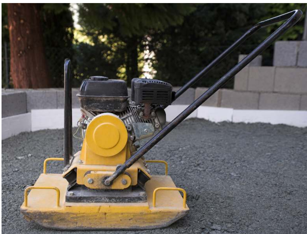
A motor egy nehéz talplemezt mozgat, amely rezgéseivel segíti a közúzalék tömörítését. [73]
