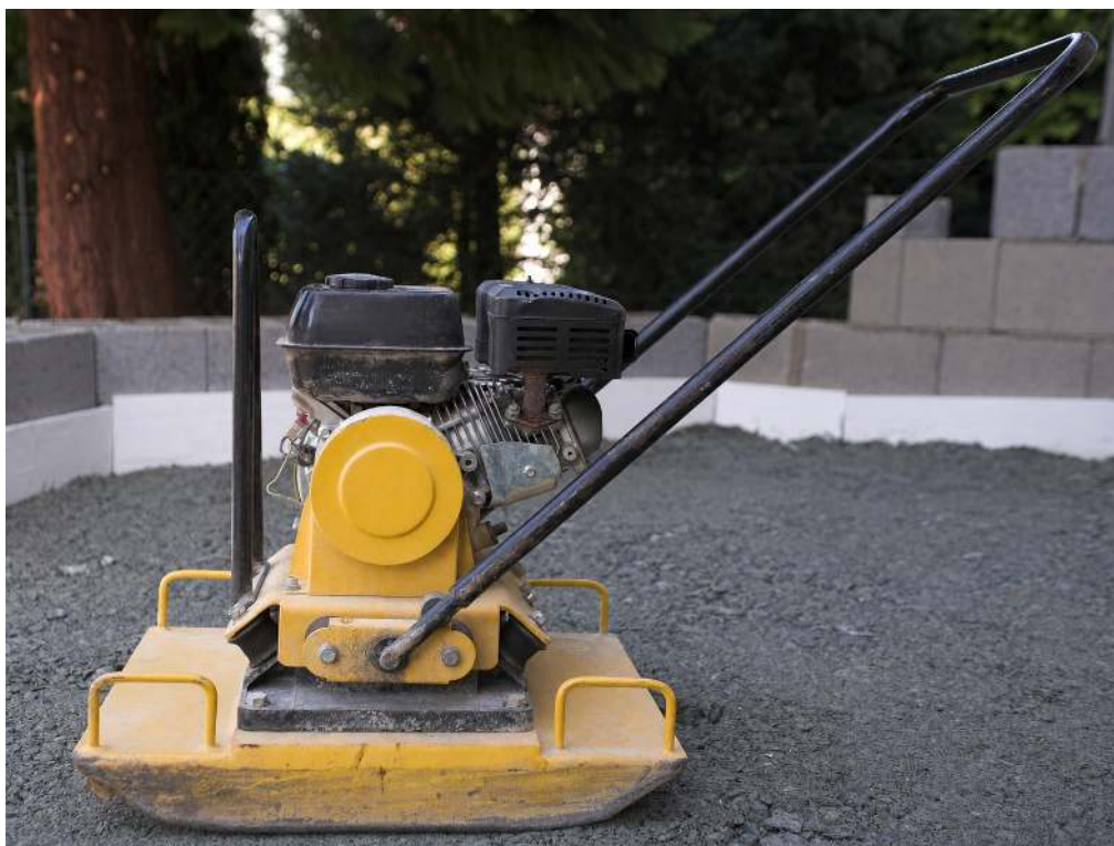
Motor pohání těžkou spodní desku, jejíž vibrace pomáhají hutnit vrstvu kameniva. [73]
